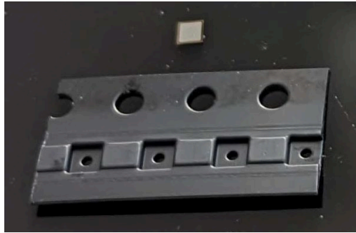
Bare die SiC MPS diode (1.4 mm x 1.4 mm)
