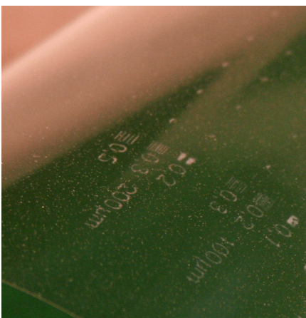
Fig. 1: Mittels Tintenstrahldruck erzeugte Strukturen aus ZnO-Nanopartikeln auf PET-Folie; Features made from ZnO nanoparticles ink-jetted onto PET substrate.
