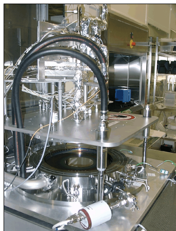
Fig. 2: MOCVD-Reaktor am IISB (links) und Dicke einer Zirkonsilikatschicht auf einer 150 mm Scheibe (rechts); MOCVD reactor at IISB (left) and thickness mapping of a zirconium silicate layer deposited on a 150 mm wafer (right).
