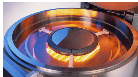
Fig. 1: Abscheidungskammer des TriCent®-Reaktors (mit freundlicher Genehmigung von AIXTRON AG); Deposition chamber of the TriCent®-reactor (courtesy of AIXTRON AG).
