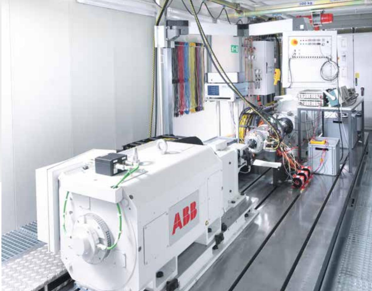
Fahrzeuge mit elektrischem Antriebsstrang stellen völlig neue Anforderungen an die Meß- und Prüftechnik. Speziell auf diese Anforderungen zugeschnitten bietet das neue Testzentrum des Fraunhofer IISB in Erlangen eine einzigartige Infrastruktur, in der einzelne Komponenten von Elektrofahrzeugen bis hin zu Gesamtfahrzeugen vermessen und optimiert werden können.
